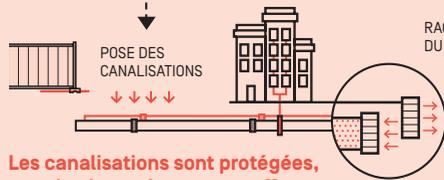
Les canalisations sont protégées, sous la chaussée, par un coffrage en béton armé.
