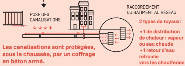
Les canalisations sont protégées, sous la chaussée, par un coffrage en béton armé.
