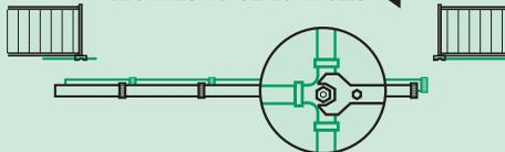
Les canalisations sont protégées, sous la chaussée, par un coffrage en béton armé.
